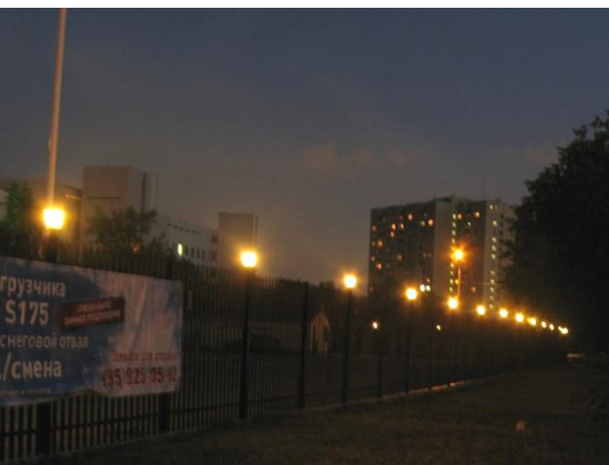
Периметр территории офисного здания. Лампы 5 Вт VK-27B5CP1 в плафонах фонарей наружного освещения. Отсутствие влияния температуры на режим работы позволяют применять светодиодные решения для уличных плафонов.
