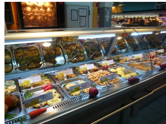
Сеть супермаркетов. Подсветка прилавков-холодильников. Лампы 11 Вт VK-8060B09AC. Отсутствие ультрафиолетового излучения в спектре ламп помогает дольше сохранить продукты.
